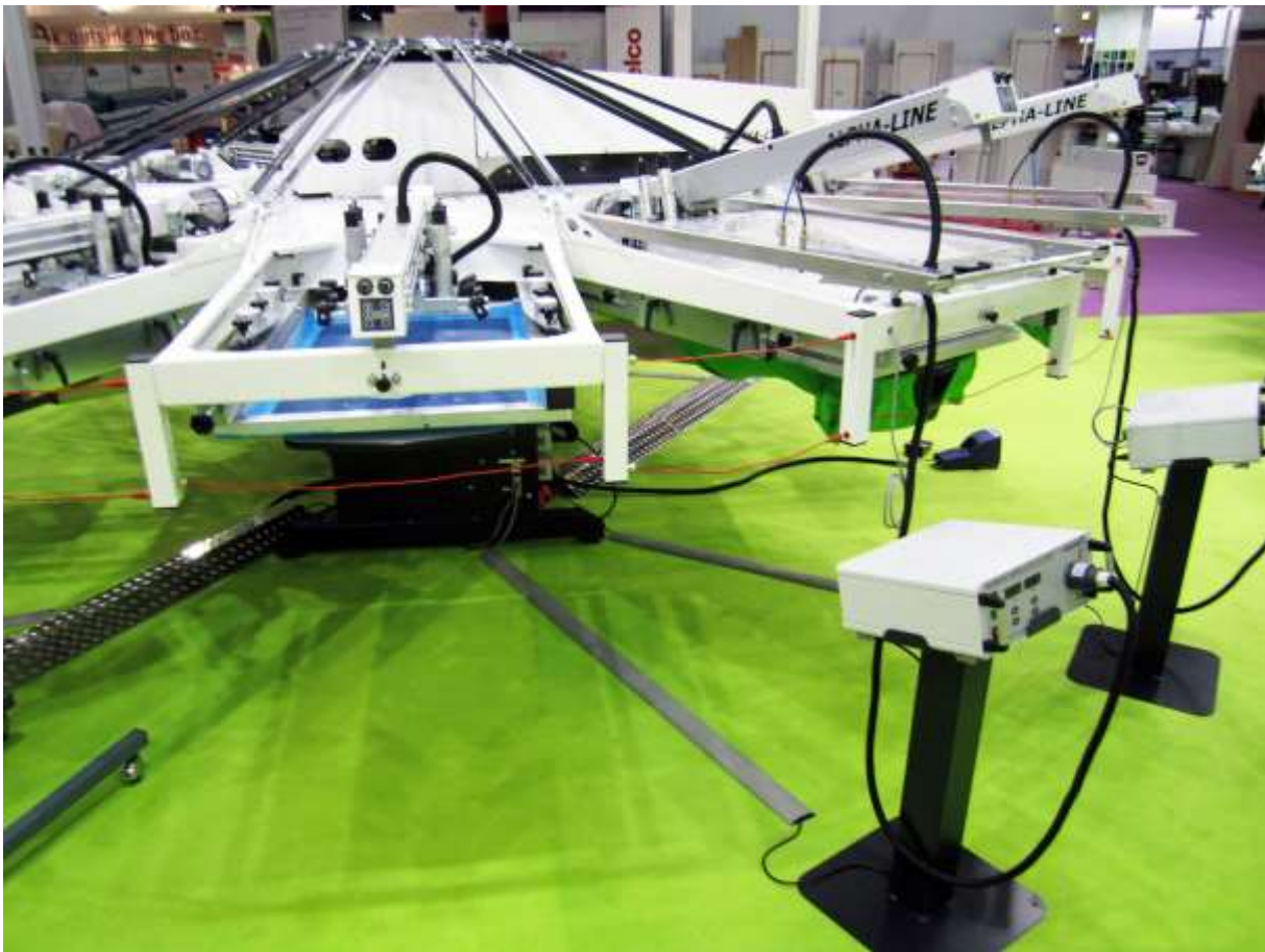
Abb. ALPHA-LINE-COMBI – max. Druckfläche 500 x 700 mm – max. Flockfläche 400 x 500 mm
